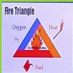
Fig. 6: De 3 componenten die nodig zijn om vuur te laten ontstaan(MOW-WLA, 2025)
